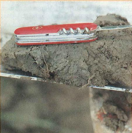
**11** Wenn der Boden rot- oder dunkelbraun ist, deutet das auf genügend Luftsauerstoff hin. Je nach Humusgehalt wird die Farbe heller oder dunkler. Bei gehemmter Durchlüftung wird Mangan ausfallen, es zeigen sich schwarzbraune, ausschmierbare Punkte. Bei stärkerem Luftmangel wird Eisen reduziert und der Boden zeigt eine rostfleckig bis graublau Farbe.
