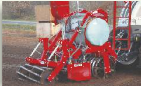
Rohrstabwalze Ø 45cm kombiniert mit Dachringwalze Ø 62cm.
