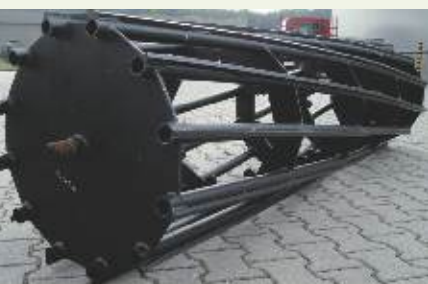
Rohrstabwalze mit Vierkantstahl 14x14 mm für aggressive Stoppelbearbeitung.
