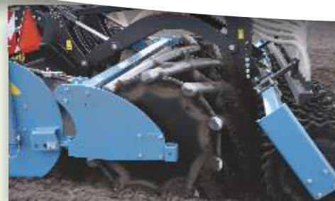
Rohrstabwalze Ø 100 cm mit 3 "Rohre für zusätzliche Kapazität.
