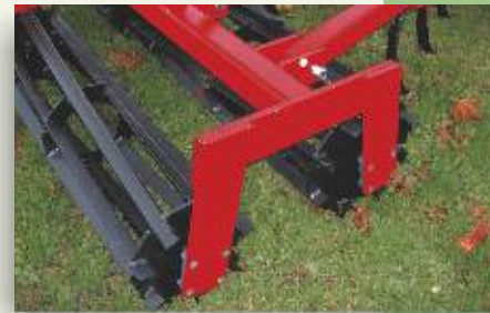
Walze Ø36cm und 45cm mit Winkleisen 45x45x6mm.
