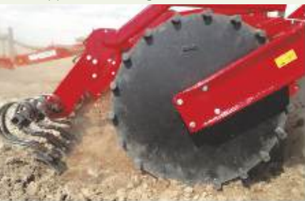
Rohrstabwalze Ø 100 cm in Kombination mit Levelling Board.
