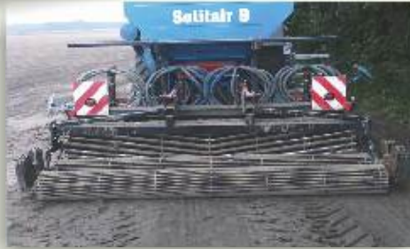
Doppelte Walze Ø 360 mm mit 10 mm Steben.
