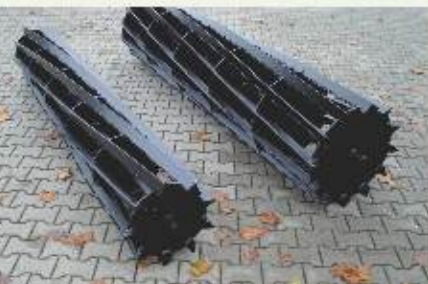
Walze mit Winkel- und Flacheisen. Durchmesser 45 cm und 62 cm für aggressive Stoppelbearbeitung.
