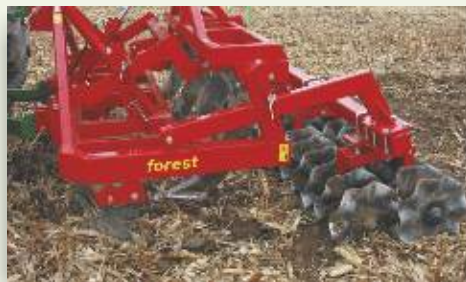
Schnittwalze zum Zerschneiden von Ernte-Rückständen.
