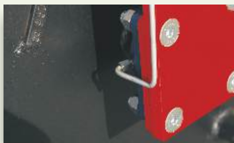
Flanschlager versehen mit Zentral Schmierung.
