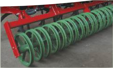
Walze auf Kundenwunsch hinter Ackerlandinjektor montiert.
